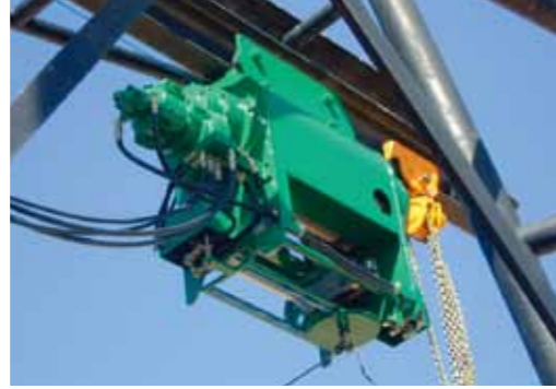
型式：MAWKH-25 定格荷重：2.5ton 巻上速度：5m/min エア源：0.5MPa 特長：メカニカルブレーキを使用 設置場所：アルジェリア国
