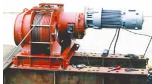
型式：MT-20G13 巻上荷重：1.5ton 巻上速度：16m/min
