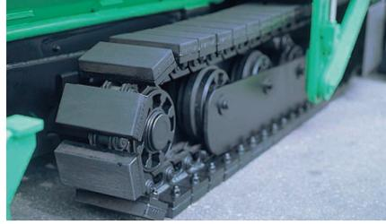
クローラは耐久性のある好評のゴムパッド付で、クラストップの牽引力で舗装路面も安心して走行でき、クローラ張調整は、グリースアップ式で容易に調整できます。
