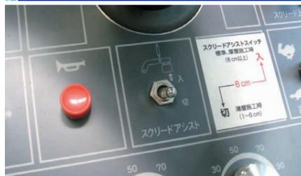
路盤材施工などの厚層舗装時、また軟弱路盤などで使用します。
