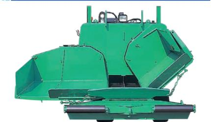
ホッパは2段折畳式で、油圧シリンダによる左右単独操作が可能。舗装現場に合わせて調整ができ、また障害物も避けられ大変便利です。
