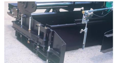
スクリュより左右に送られる合材量をフレーム後部の両サイドに設けた検知センサーによりフィーダ、スクリュの駆動と連動し、自動制御ができます。
