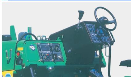
使用頻度の高いスイッチ類を運転席操作パネルに集中配備。また、前後進は走行レバー1本で任意な速度が得られ、安全かつ効率的に舗装作業が行えます。
