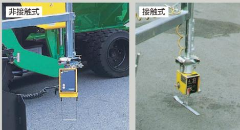
施工条件に応じて、接触式及び非接触式の取付が可能です。
