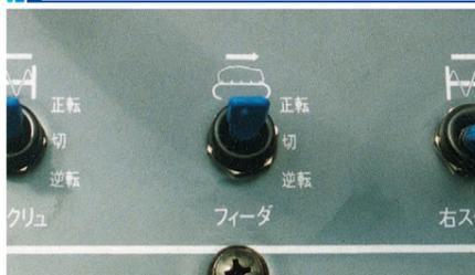
路盤材がフィーダに噛み込んだ時は、スイッチ操作によりフィーダを逆転して外せます。
