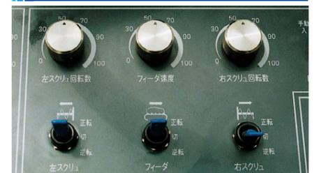
合材自動供給システム使用中も単独制御可能としました。フィーダとスクリュのスピードコントロールは電磁比例(可変)式とし、作業に最適な搬送量と横送り量が得られます。またスクリュは左右単独・正逆回転操作も可能です。
