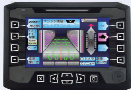
スクリュ・コンベヤ搬送状態
