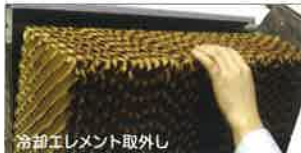
冷却エレメント取外し
