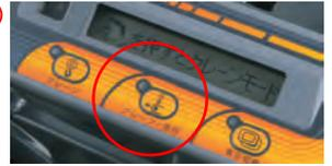
クレーンモード時にLEDの外部表示灯が点灯
