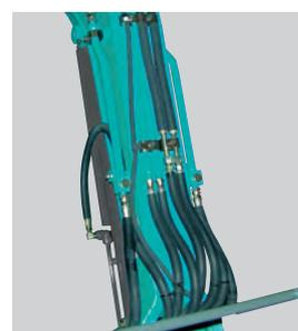
万一のホースの破裂時に、圧油がオペレータにかかるのを防ぐフロントホースカバー。
