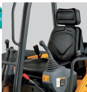
体重に合わせて調整できるサスペンションシートと、オペレータを守る巻き取り式シートベルトを採用。
