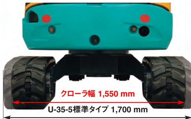
脚幅を1550mmの狭幅タイプにすれば、進入路が狭い現場の場合に威力を発揮します。
