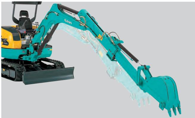
優れた深掘り能力で作業範囲の拡大はもちろん、アームの伸縮により法面作業や角堀作業の能率も大幅にアップします。
