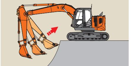
ブーム上げ時、ブームシリンダからの圧油をアーム動作に再利用します。圧力が高められたブームシリンダからの圧油がアーム引き動作に活用されることで、アーム引きのスピードアップと燃費の低減を実現します。
