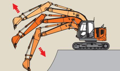
ブーム下げ時にフロントの自重を利用して圧油をブーム回路内で循環（再生）させます。ポンプからの圧油を集中的にアーム動作に利用することができます。これによりアーム／ブーム下げ複合動作のスピードアップと燃費の低減を実現します。
