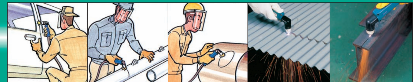
自動車板金の切断作業 パイプの切断作業 製缶加工の穴アケ作業 波板の切断作業 H形鋼の切断作業
