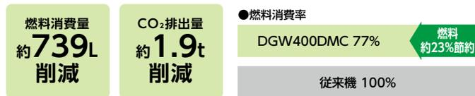
算出方法は、溶接や交流機器使用の一般的な作業条件をもとに計算。単位燃料あたりのCO<sub>2</sub>排出量は2.62kg/L \*DGW400DM
