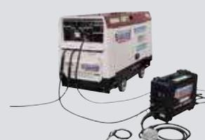
別名、ノンガス溶接と呼ばれ、基礎工事における鋼矢板や鋼管杭などの溶接に最適。専用のフラックス入りワイヤにより、シールドガスが不要なので、ホースの取り回しやポンベの管理が不要です。ワイヤ送給装置やトーチも「国産」でトラブルにも迅速に対応できます。
