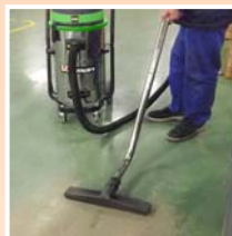
▲静電気対策ホースが標準付属。 粉体を強力に吸引します。
