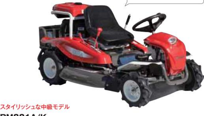
機能充実のコンパクトモデル RM83G/H エンジン／9.7kW(13.0PS) 刈幅／820mm 最大能率(3速時)／41.8a/h 希望小売価格(税込) ¥591,840 ¥548,000(税抜)
