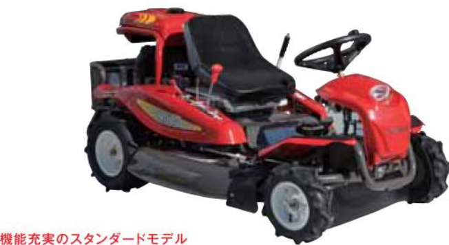
機能充実のスタンダードモデル RM951A/K RM951A/B エンジン／K:13.4kW(18.0PS相当)／B:13.2kW(18.0PS) 刈幅／950mm 最大能率／95.0a/h 希望小売価格(税込) ¥802,440 ¥743,000(税抜)
